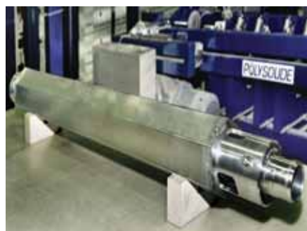
Опытный образец ТВС для первой в мире плавучей АЭС
